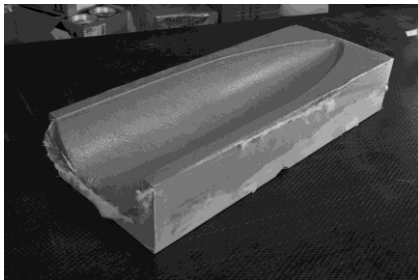
Рис. 9. Матрица для формования панели обтекателя из ПКМ
