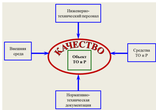
Рис. 1. Структура системы технического обслуживания и ремонта
