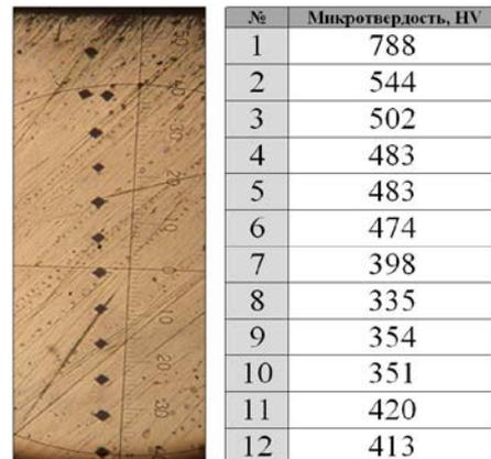
Рис. 5. Распределение микротвердости по ширине паяного шва
