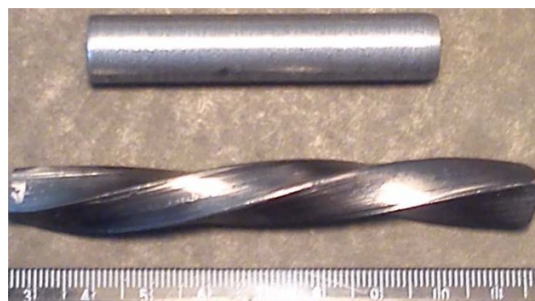
Рис. 1. Стальные заготовки до (а) и после (б) комбинированной обработки
