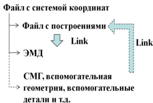
Рис. 6. Структура файла с системой координат
