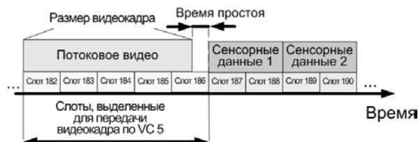
Рис. 10. Пример простоя передачи данных по виртуальному каналу
