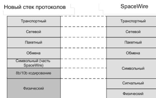
Рис. 1. Сравнение стека протоколов SpaceWire и GigaSpaceWire
