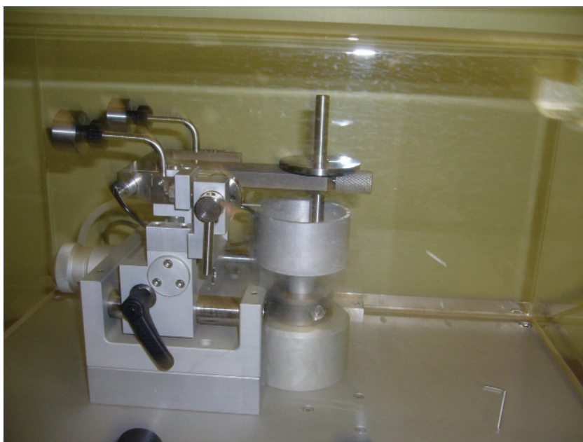
Рис. 3. Испытания образцов в жидком азоте
