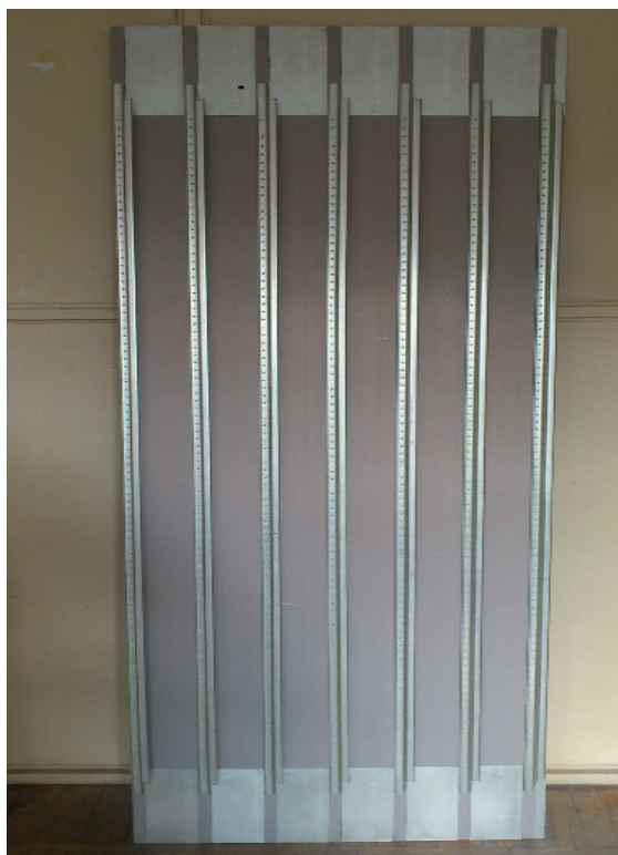
Рис. 2. Вид фрагмента обшивочной панели габаритами 820x2400 мм из алюмокомпозитного материала СИАЛ-1441 со стрингерами
