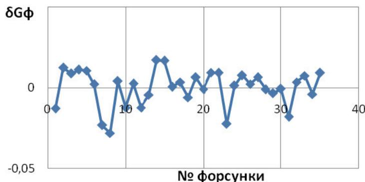
Рис. 6. Отклонение расхода воздуха через форсунки от среднего значения
