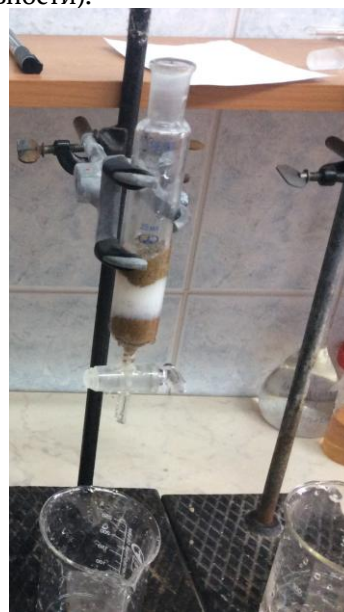
Рис. 4. Многокомпонентный адсорбционный фильтр. Состав (в порядке от верхнего слоя к нижнему): бентонит, модифицированный углеродными нанотрубками (УНТ), t обжига 550°C; анионообменная смола Purolite A 860 S; бентонит, t обжига 550°C
