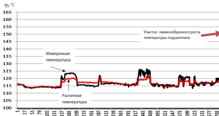
Рис. 8. Сравнение величин расчетной (по модели) и измеренной температуры подшипника в ходе аварии (разрушение радиально-упорного подшипника ротора ВД)
