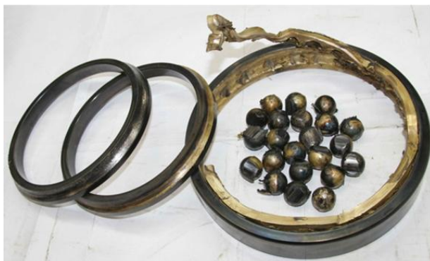
Рис. 1. Пример состояния радиально-упорного подшипника после аварии
