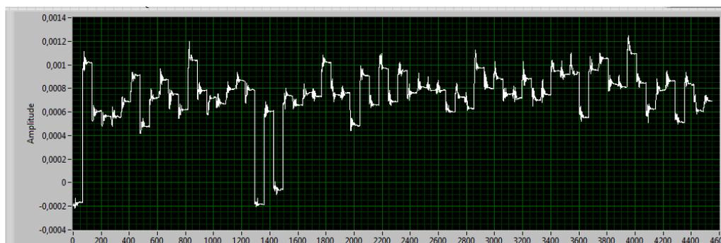
**Рис. 6.** Восстановленный сигнал на выходе системы автоматической подстройки синхронизации по максимальному значению ВКФ и график ВКФ
