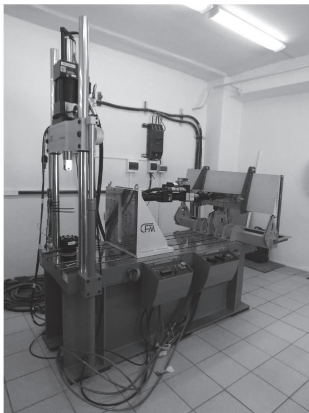
**Рис. 2.** Сервогидравлическая машина MTS 793
