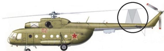
Рис. 1. Схема расположения приемо-передающего модуля на хвостовой балке вертолёта
