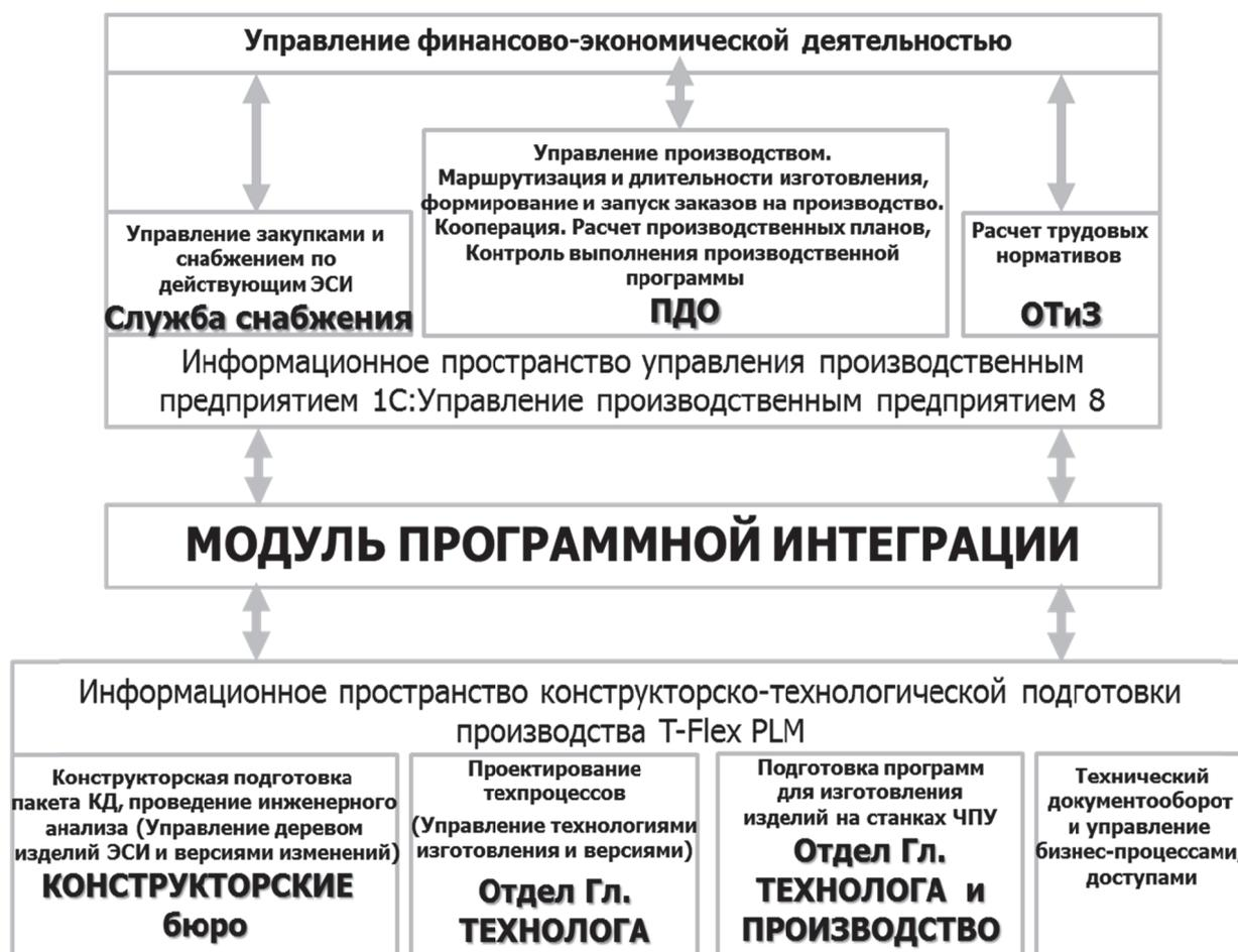
Рис. 1. Функциональная схема ЕИП предприятия
