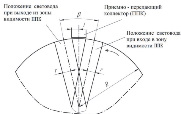
Рис. 3. Геометрические построения, определяющие угловое расстояние \beta между световодами, формирующими зондирующее излучение
