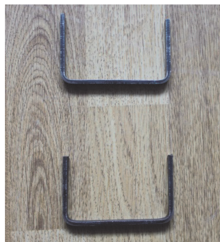
Рис. 6. Полученные детали из стали 3 при помощи штампа для двухугловой гибки с упругим элементом
