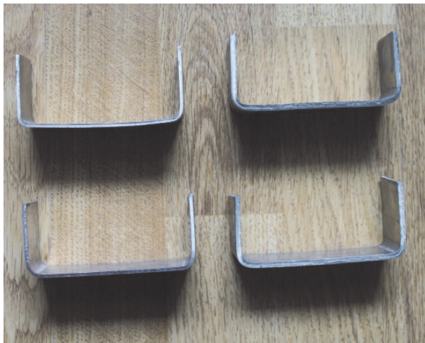
Рис. 9. Полученные детали из алюминиевого сплава А5 при помощи штампа для двухугловой гибки с упругим элементом
