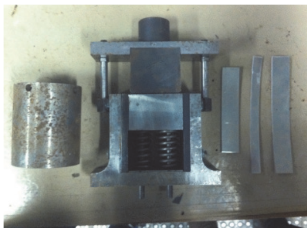
Рис. 3. Экспериментальный штамп для двухугловой гибки с упругой планкой (общий вид)
