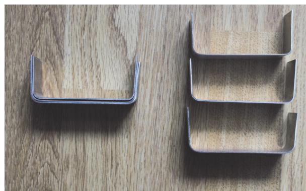
Рис. 7. Полученные детали из алюминиевого сплава А5 при помощи штампа для двухугловой гибки с упругим элементом
