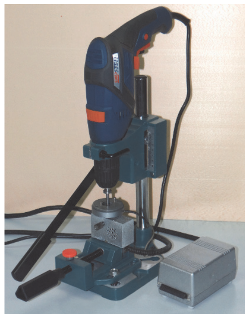
Рис. 4. Простой трибометр с приводом от ручной дрели
