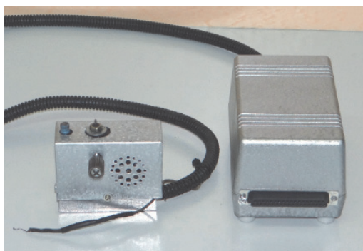
Рис. 3. Измерительная система трибометров серии «Универсал»
