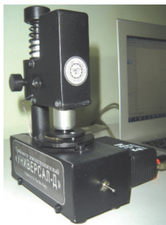
Рис. 2. Малогабаритный демонстрационный трибометр «Универсал-Д»
