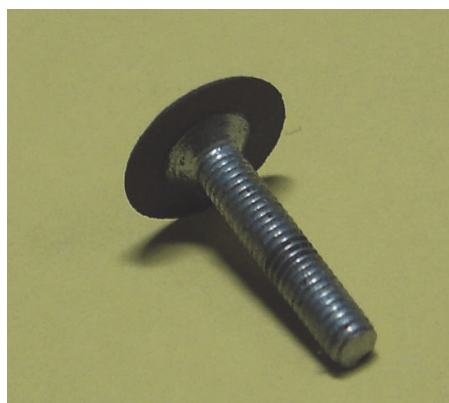
Рис. 3. Характерная эпюра нагружения (а) и общий вид (б) толкателя (винт М3) с оторванной частью покрытия после испытаний
