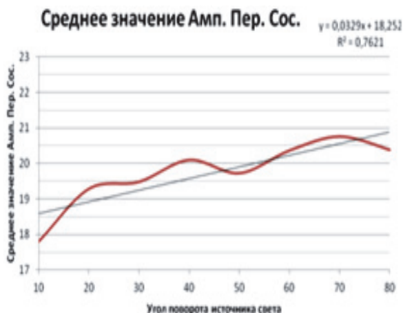
Рис. 7. Влияние угла наклона источника света на среднюю амплитуду автокорреляционной функции
