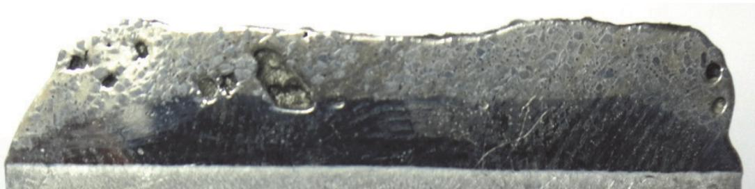
Рис. 9. Образец №3 - наплавка шнуром (60WC 40Ni) с подслоем никеля
