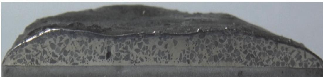
Рис. 8. Образец №1 - наплавка шнуром - 60WC 40Ni без подслоя
