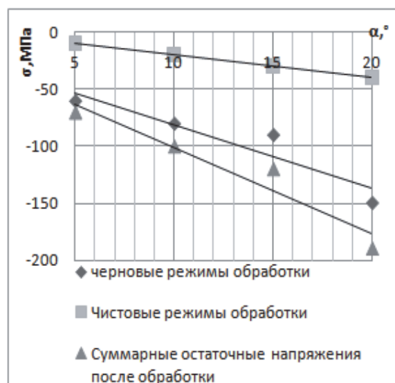
Рис. 4. Влияние величины остаточных напряжений от положения жестких опор
