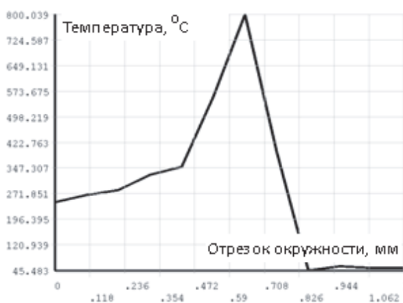
Рис. 5. Распределение температуры в зоне шлифования по окружности в момент времени 6,336 с
