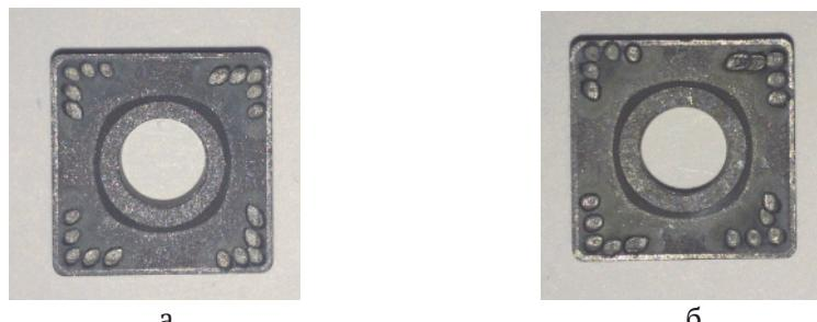
**Рис. 1.** Внешний вид пластин твердого сплава T15K6 после лазерной обработки:
