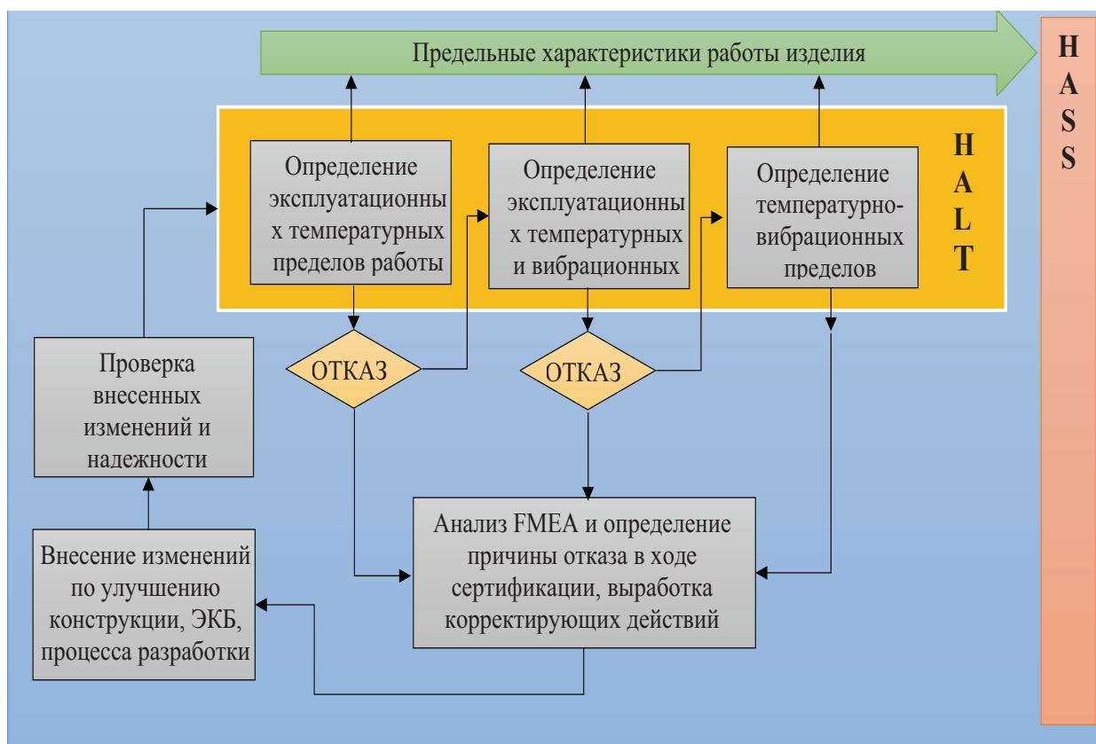
Рис. 6. Технология испытаний HASS
