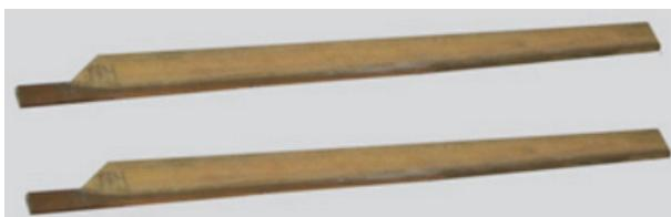
Рис. 2. Заготовка лопасти вертолета «Беркут»
