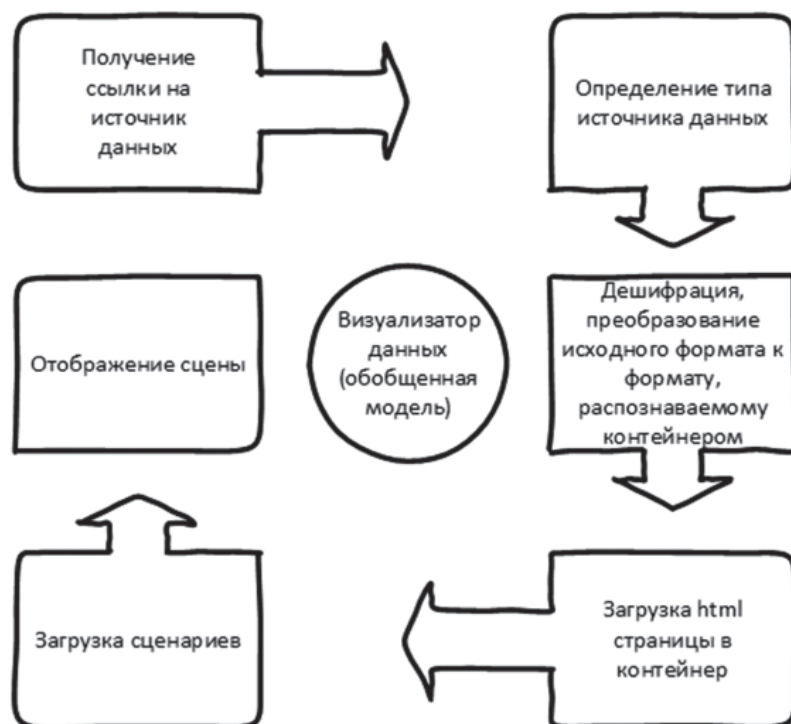
Рис. 2. Обобщенная модель визуализатора данных ЭМИ
