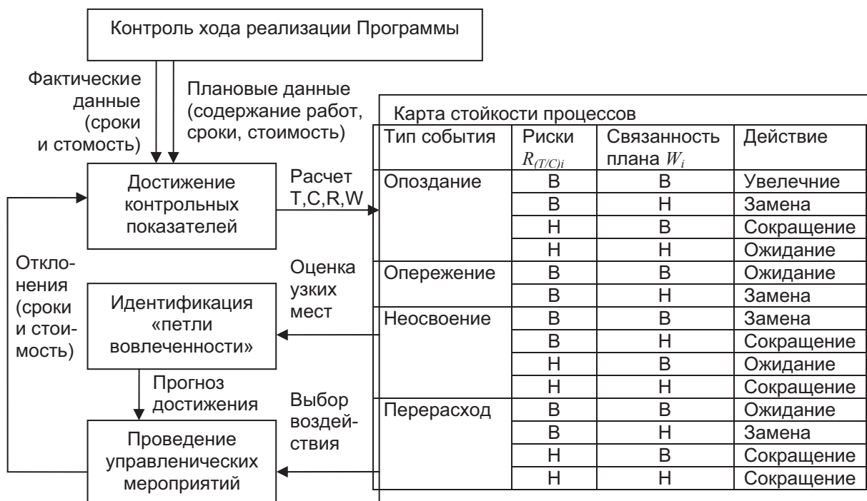
Рис. 3. Метод рационального управления строительством объектов сети ЦТВ
