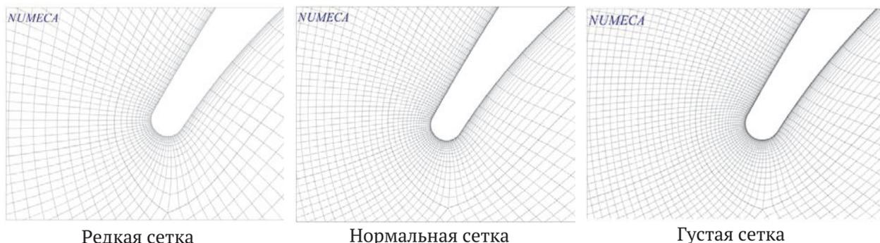
Рис. 3. Сравнительное изображение сеток конечных объемов созданных расчетных моделей
