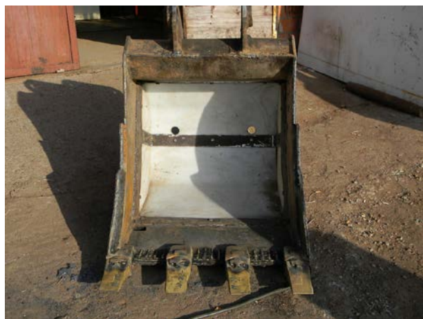
Рис. 2. Ковш экскаватора ЕК-18 с ППЛ ЭИ до эксплуатации
