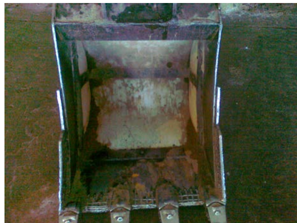
Рис. 3. Ковш экскаватора ЕК-18 с ППЛ ЭИ после эксплуатации
