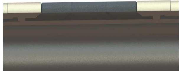
Рис. 4. Схема взаимного расположения резиновых уплотнительных колец в пакере
