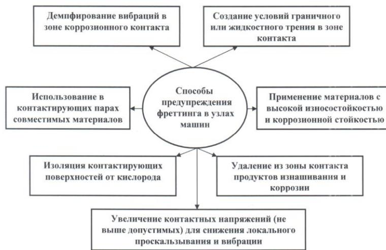
Рис. 4. Методы предупреждения фреттинг-коррозии в узлах машин
