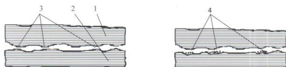
**Рис. 2.** Механизм образования каверн в зоне трибоконтакта при фреттинг-коррозии: 1 и 2 – контактирующие детали; 3 – точки контакта поверхностей; 4 – зарождающиеся каверны
