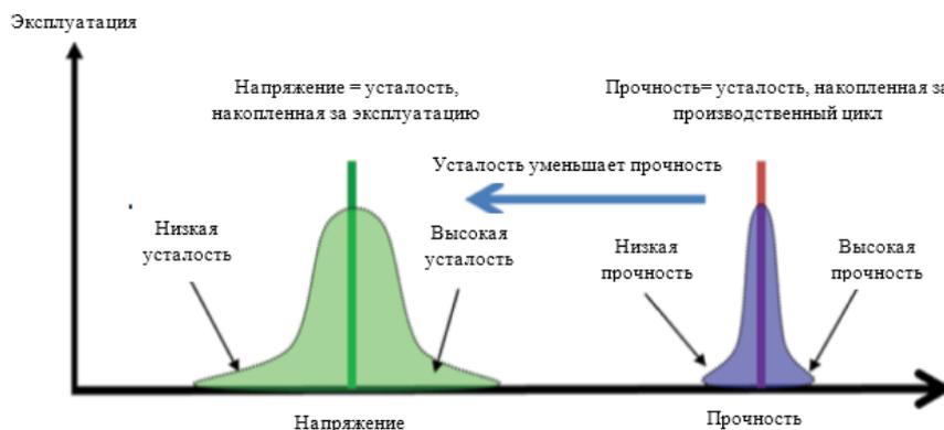
Рис. 4. Диаграмма распределений прочность-напряжение и эффект накопление усталости
