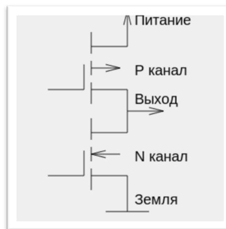
Рис. 1. КМОП выход микросхемы
