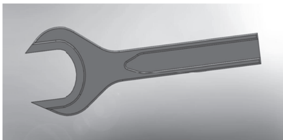
Рис. 1. Модель гаечного ключа, полученная в SolidWorks
