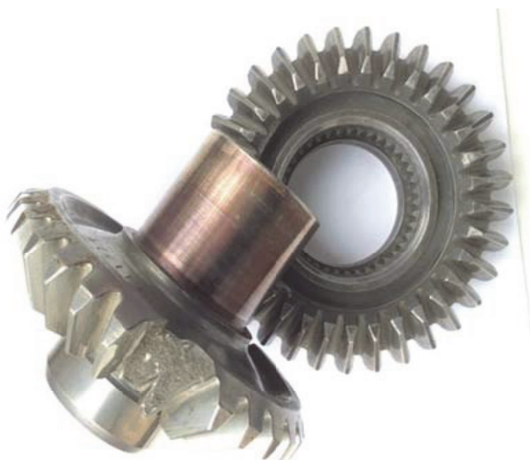
Рис. 4. Вид испытываемых зубчатых колес и виды поломок колес с e_a > 2
