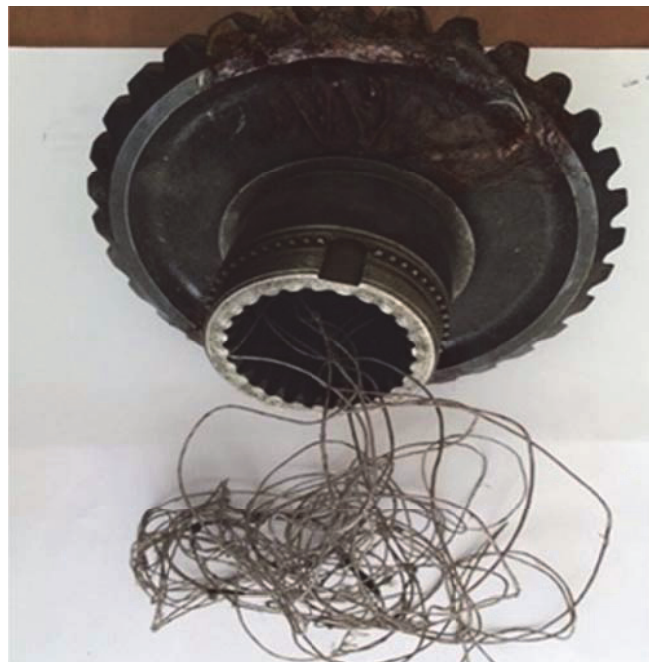
Рис. 2. Внешний вид препарированного тензодатчиками зубчатого колеса
