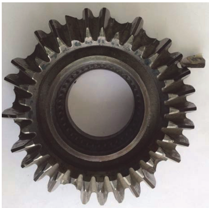
Рис. 3. Вид поломки зуба колеса при e_a < 2
