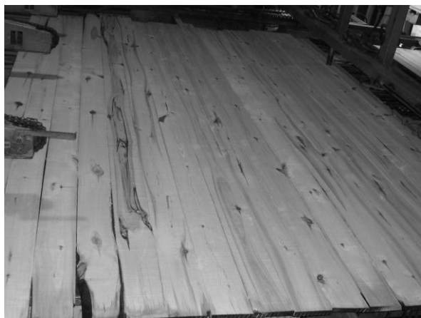
Рис. 2. Качество пиломатериалов, получаемых из осины
