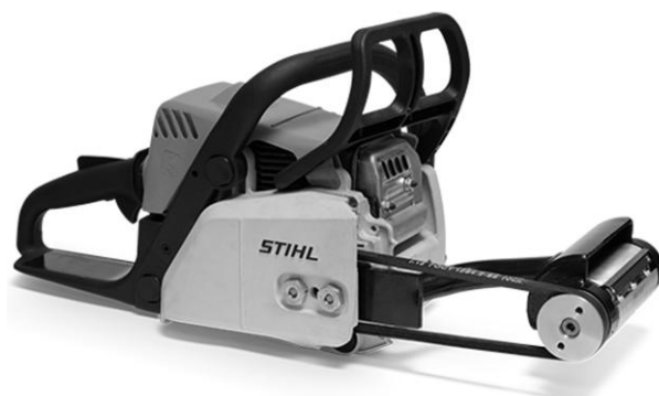
Рис. 4. Приспособление для снятия коры при окольцовывании осины
