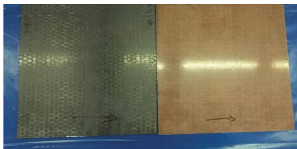
Рис. 3. Образцы панели пола, изготовленные по последовательной схеме формования
