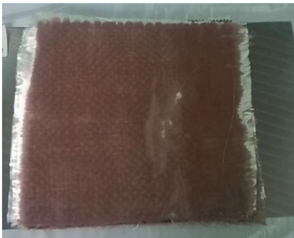
Рис. 5. Клеевой препрег на основе однонаправленной стеклоткани Т-60(ВМП)-14 и пленочного клея ВК-46Б
