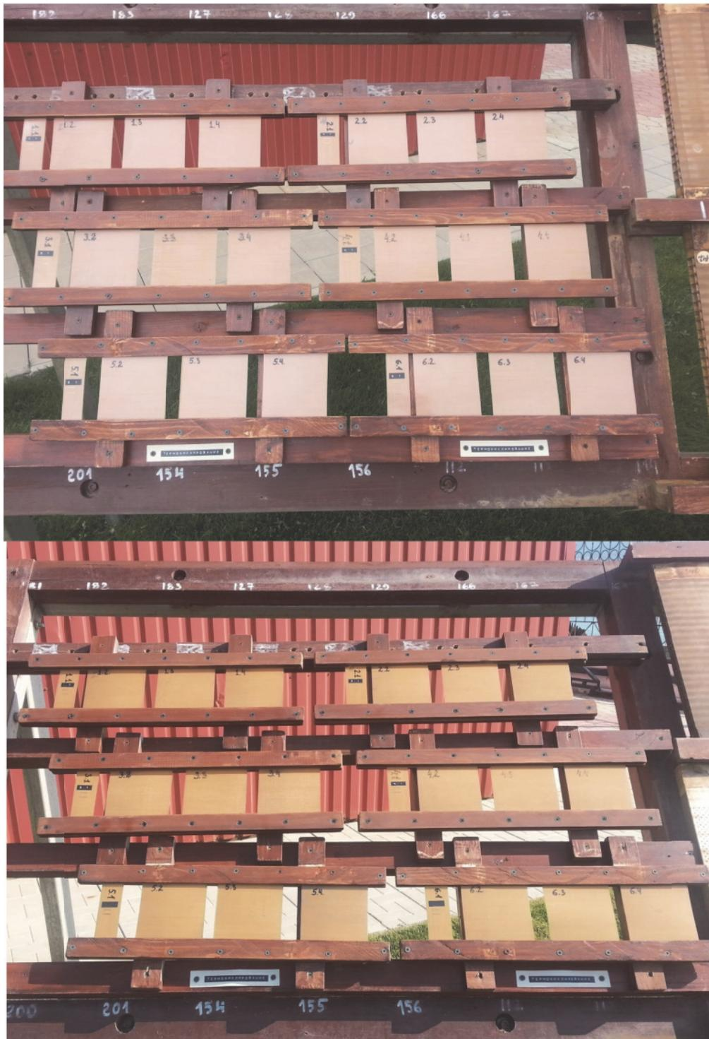
**Рис. 1.** Атмосферный стенд с расположенными пластинаами стеклопластика ВПС-53К:
