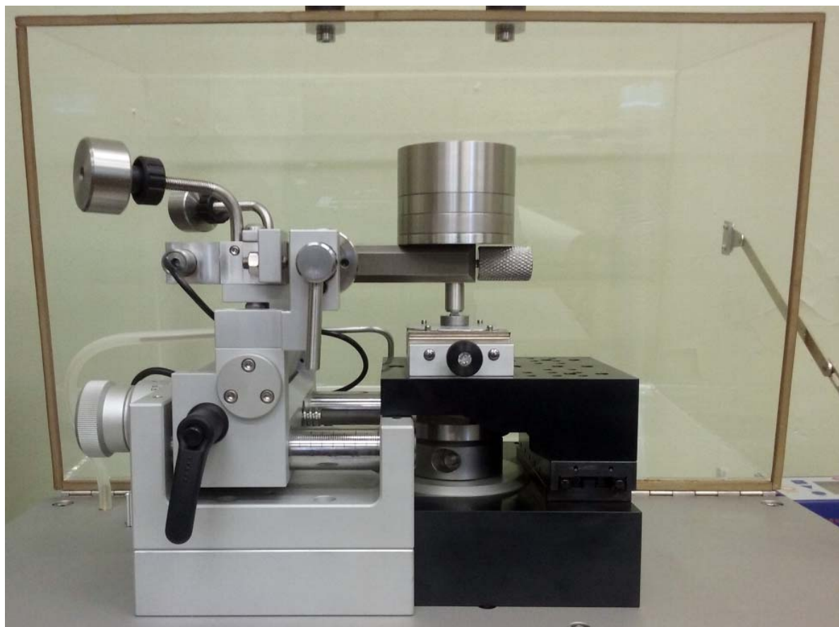
Рис. 3. Измерение коэффициента трения на трибометре CSM Instruments
