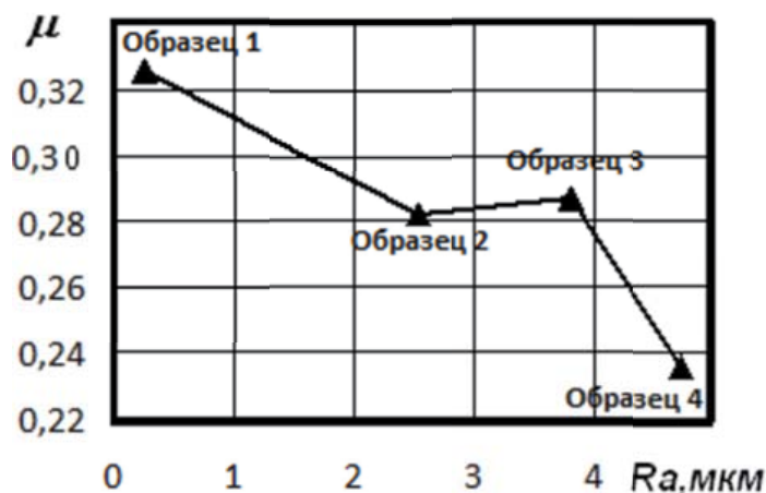
Рис. 4. График изменения коэффициента трения в зависимости от шероховатости
