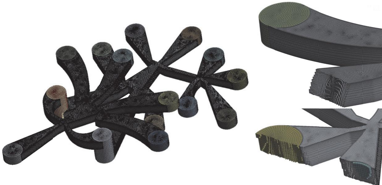
Рис. 2. Расчетная сетка струйного двухходового усилителя
