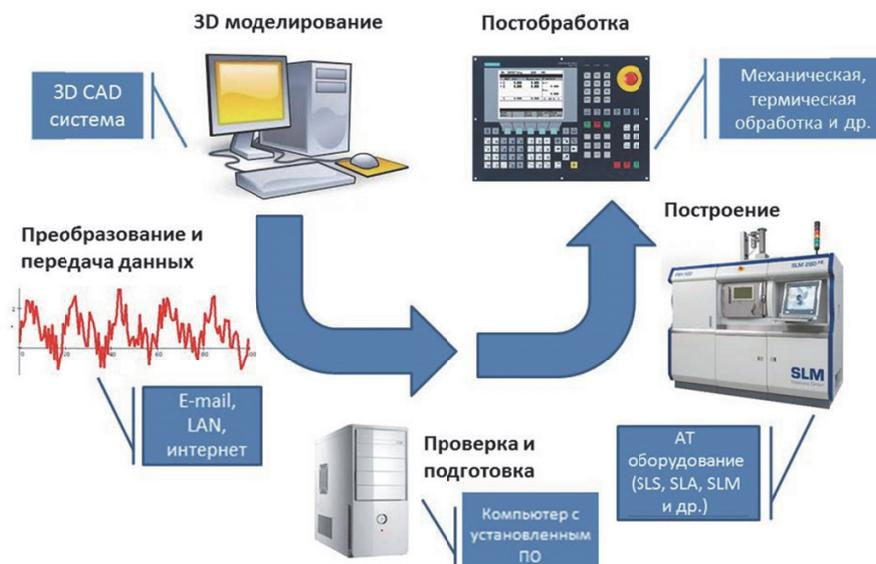
Рис. 1. Технологический процесс СЛС
