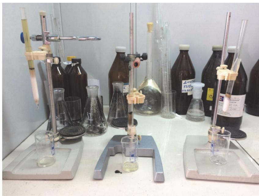
Рис. 1. Определение количества нефтепродуктов в почве гравиметрическим методом
