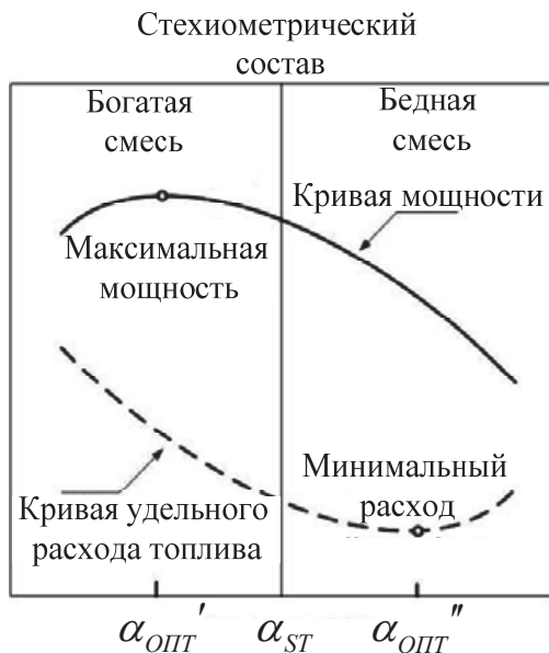
Рис. 14. Регулировочная характеристика ДВС по составу смеси
