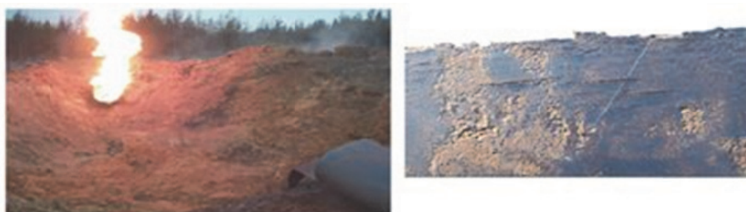
Рис. 2. Авария магистрального газопровода «Ямбург-Елец» как результат развития стресс-коррозии
