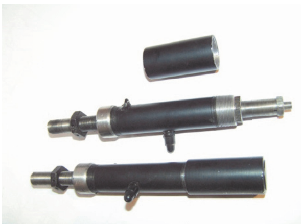
Рис. 4. Конструкция первичного СВЧ преобразователя
