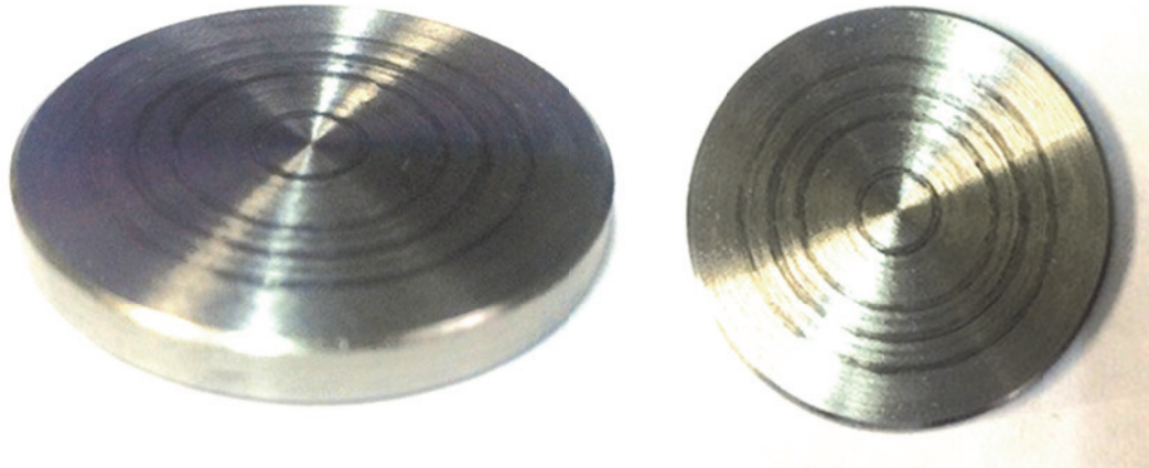
Рис. 5. Образец после испытаний и с использованием СОЖ. Общий вид (слева) и вид сверху (справа)
