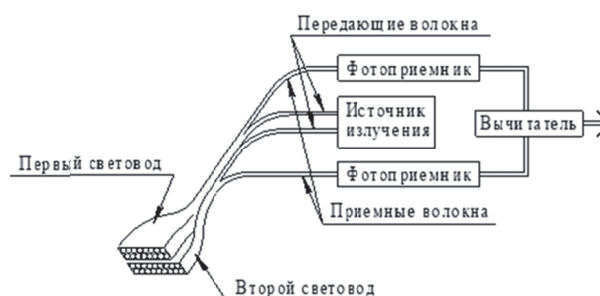
Рис. 1. Оптоэлектронный датчик положения лопаток турбоагрегата
