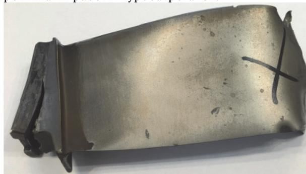
**Рис. 1.** Повреждение лопатки компрессора низкого давления ГТД ДН-80, вызванные воздействием крутильных колебаний
